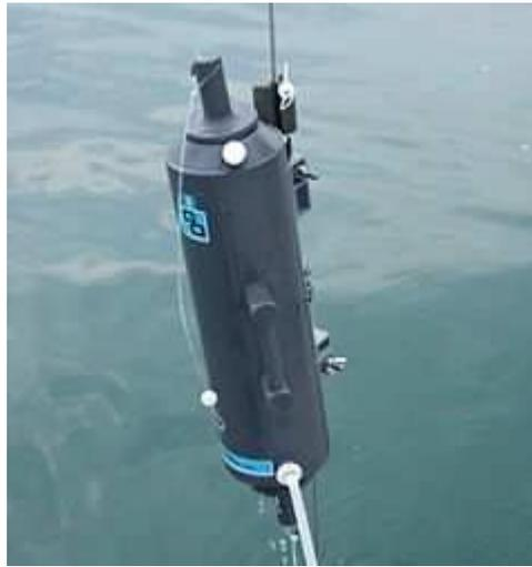
**Figure II.6 :** bouteille Niskin pour les prélèvements d'eau de mer
