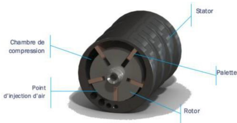
Figure I.9 : Moteur Pneumatique à Palettes.
