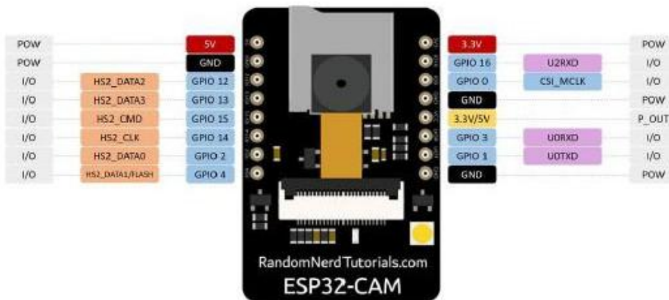
Figure II.23 : Broches de L'esp32-cam.
