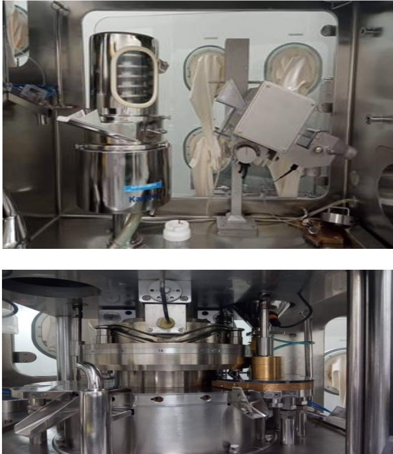
Figure 10. L'isolateur de la comprimeuse
