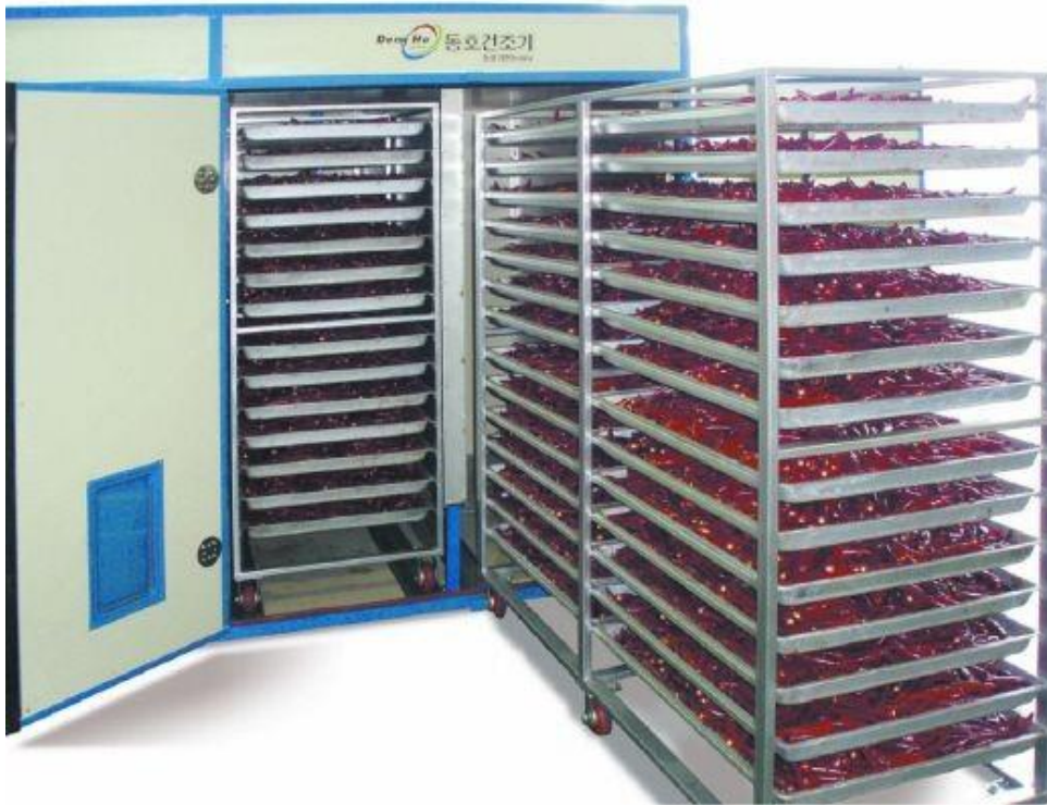
Figure 14: séchoir à plateau (Pinterest,2023)
