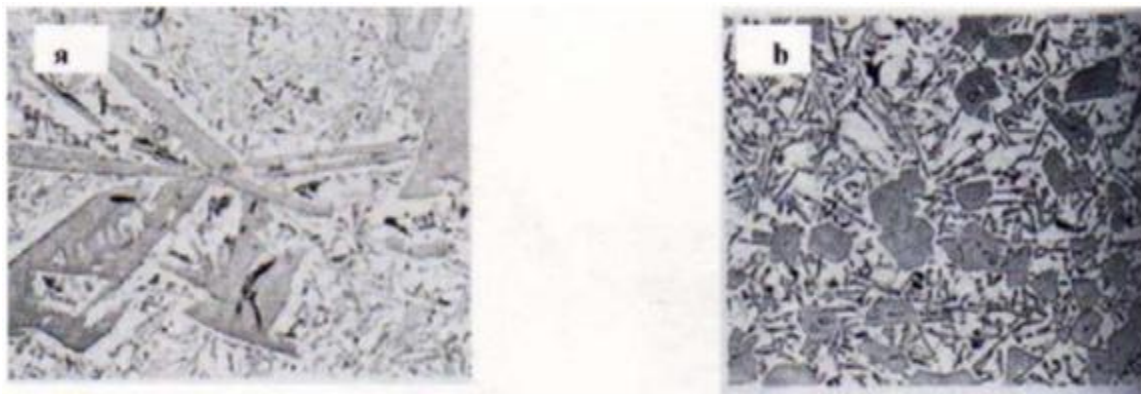
Figure II.1 : Microstructures de l'eutectique Al-Si a)-Avant modification, b)-Après modification
