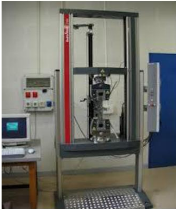
Figure III.2 : Machine de traction avec acquisition de donnée
