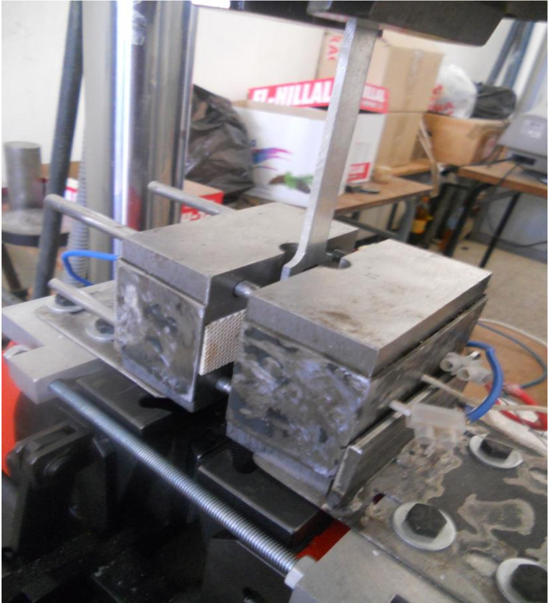
Figure IV.8 : cellule chauffante utilisée pour chauffer les éprouvettes sur la machine de traction
