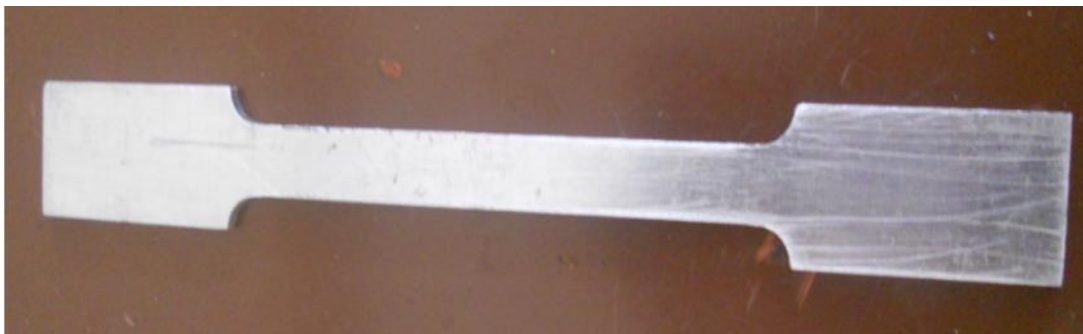
Figure IV.4 : Eprouvette utilisée pour l'essai de traction
