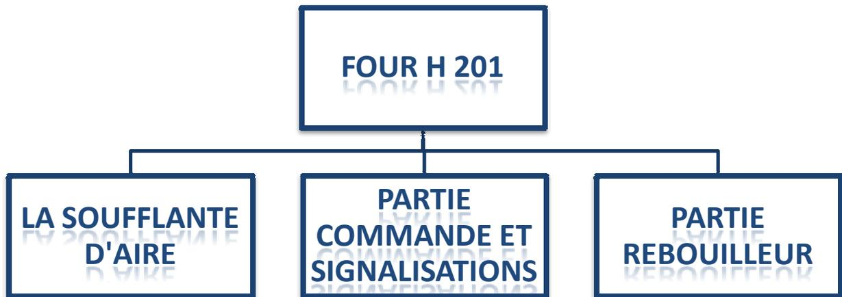
Figure II.2 : Les différentes parties du Four H201.
