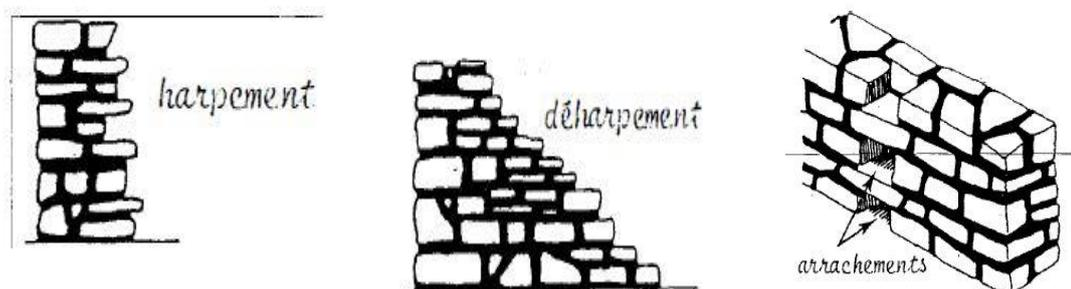
Figure 2.6 : Types de connexion des murs (AFPS, 2005).
