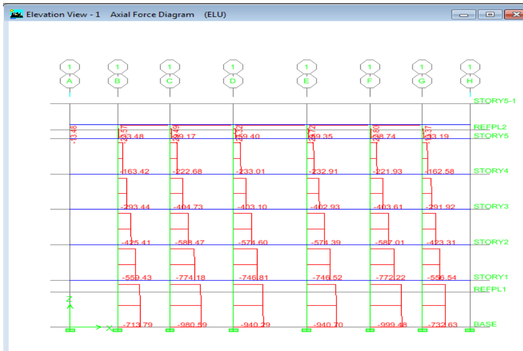
Figure VI.3: Diagramme des efforts normale du portique 1-1 Combinaisons ELU
