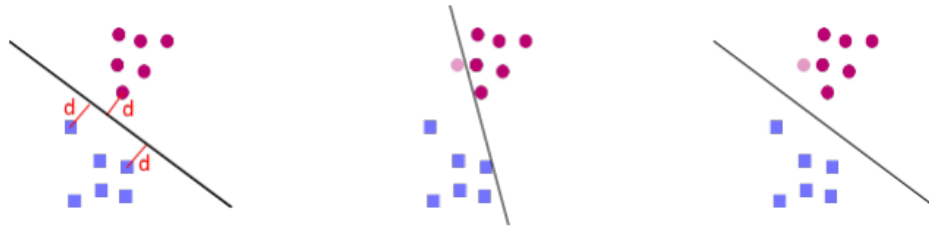
FIGURE III.3. A gauche, c'est la maximisation de la distance entre la frontière et les points d'entraînement. Au centre, une frontière non-optimale, qui passe très près des points d'entraînement. Cette frontière classe de façon erronée le rond rouge clair comme un carré bleu ! Au contraire, à droite, la frontière optimale (qui maximise la distance) classe bien le rond rouge clair comme un rond rouge.
