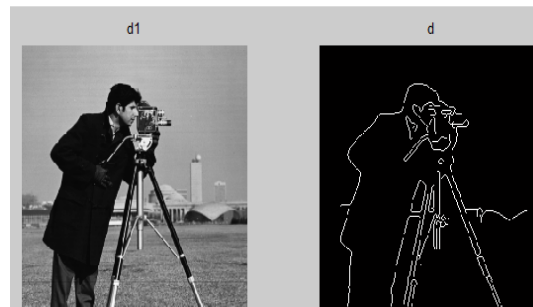
FIGURE I.10 : Image avant et après détection de contour
