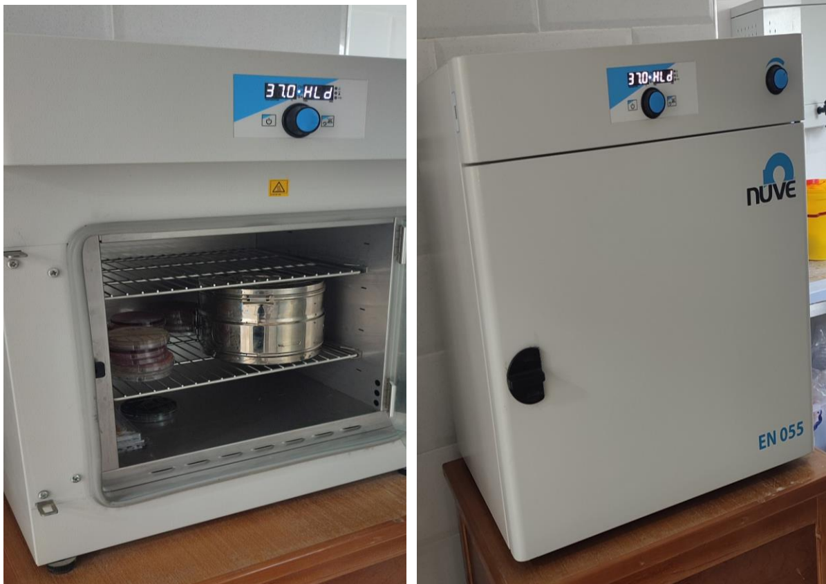
Figure 15 : Etuve utilisée au niveau du laboratoire de bactériologie de la clinique Chahid Ali Abersi (Originale, 2022)
