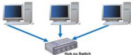
Figure A.3 : Réseau informatique en étoile
