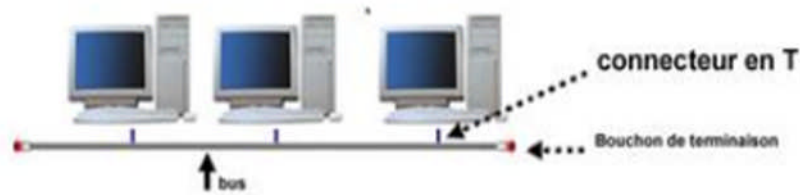
Figure A.1 : Réseau informatique en bus.
