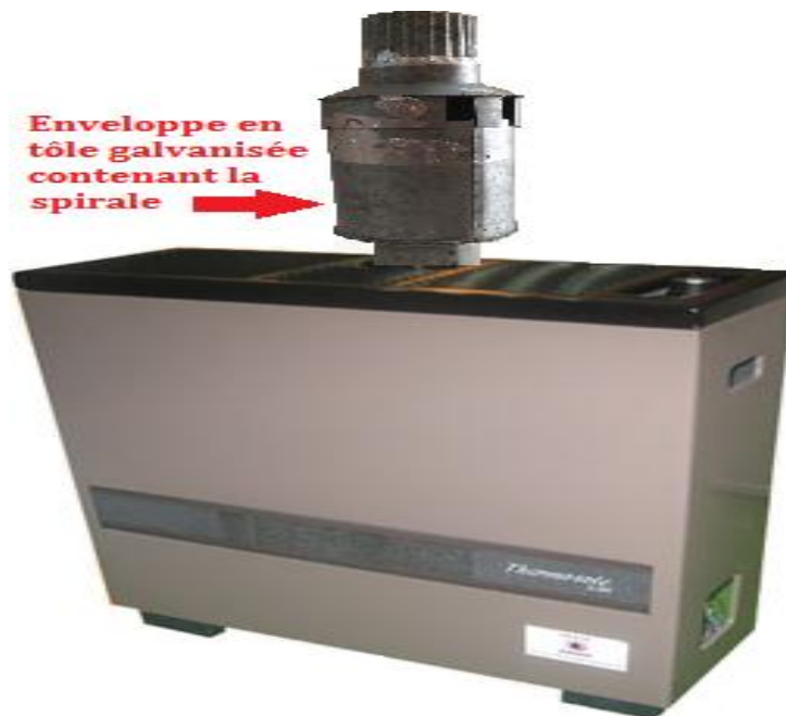
Figure III-1 : représentation de l'installation de l'échangeur en forme de spirale dans son enveloppe à la sortie des gaz d'échappement sur un chauffage fonctionnant au gaz.
