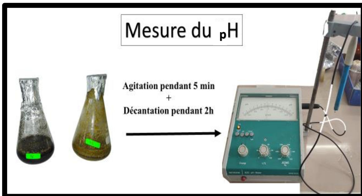
Figure24. illustration de la technique de mesure du pH (original,2022).
