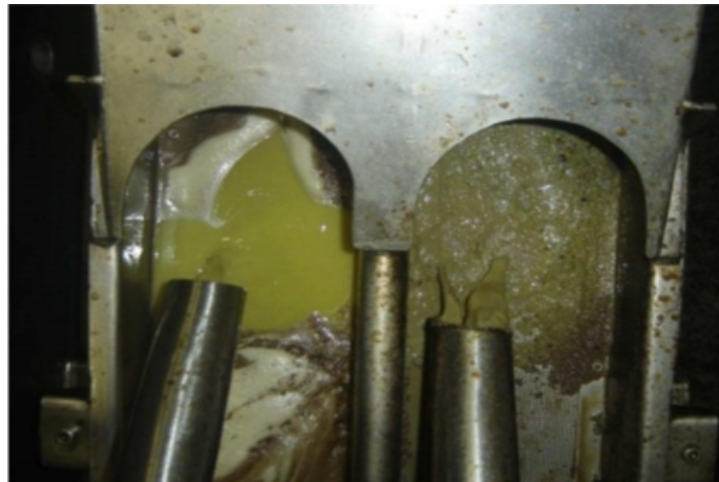
Figure 3: sortie d'une centrifugeuse 3 phases, à droite les grignons humides, à gauche l'émulsion huile/eau [17].
