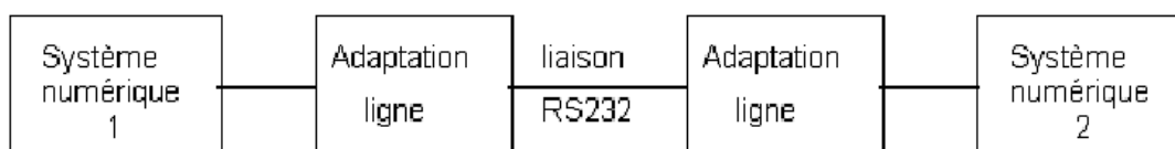
Figure -19- : Schéma fonctionnel d'une liaison série asynchrone de la norme RS232.
