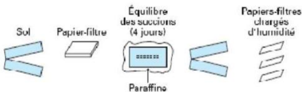
Figure II12 : Méthode du papier filtre (Dellage et All).
