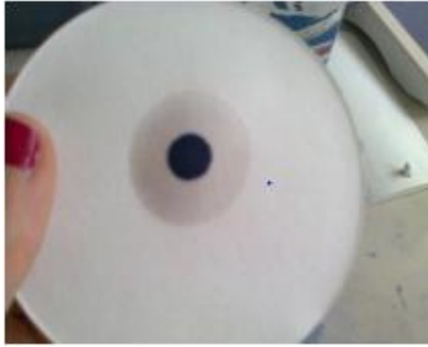
Figure III.23 : Teste au bleu de méthylène négatif.
