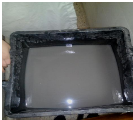
Figure III.12: Siphonnée l'eau une fois redevenue claire sans entraîner l'élément fins.
