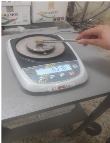
Figure IV.17 : Peser l'échantillon après l'avoir essuyé avec du papier absorbant
