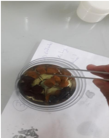
Figure IV.18 : Mettre les échantillons dans la huile de Kerdane jusqu'au on aura plus de bulle d'air
