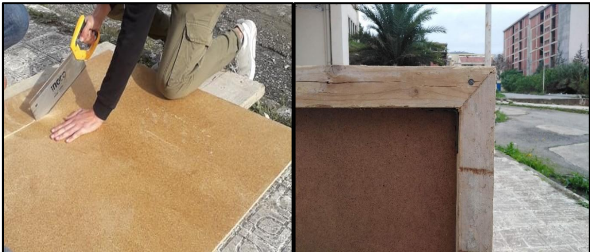
Figure I.2 : Découpe du contre-plaqué et cadres coupés à 45°
