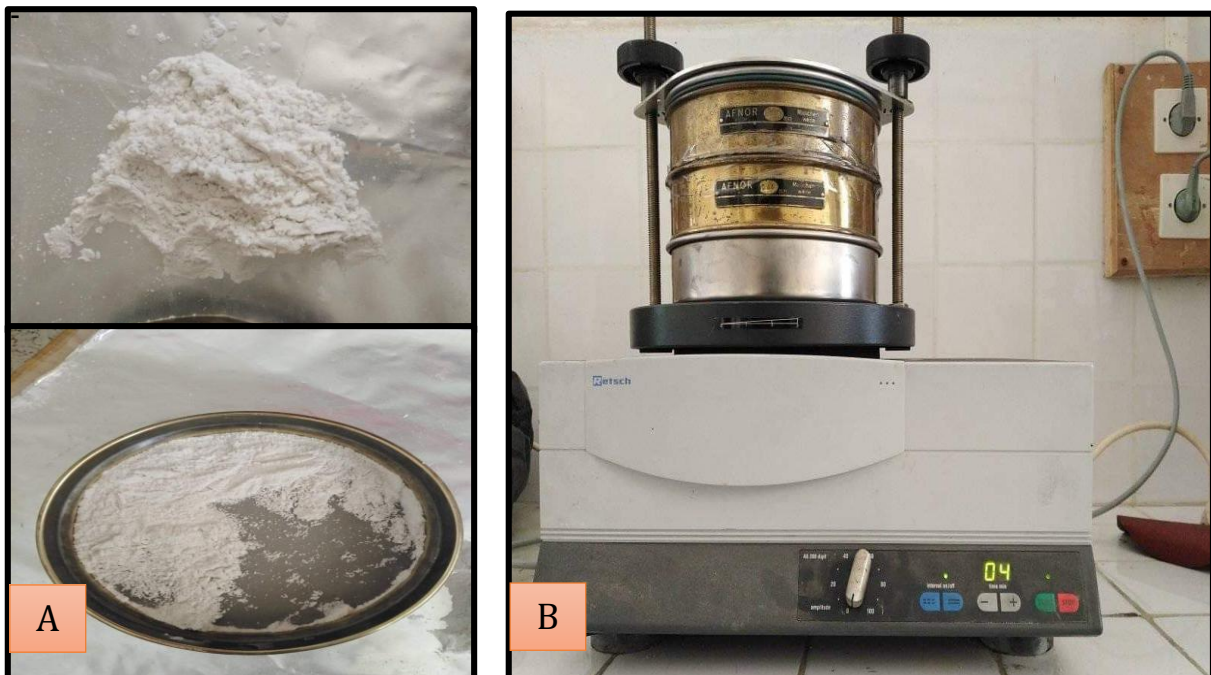
Figure I.8 : (A) tamisage de la perlite, ( B ) : tamisage du graphite
