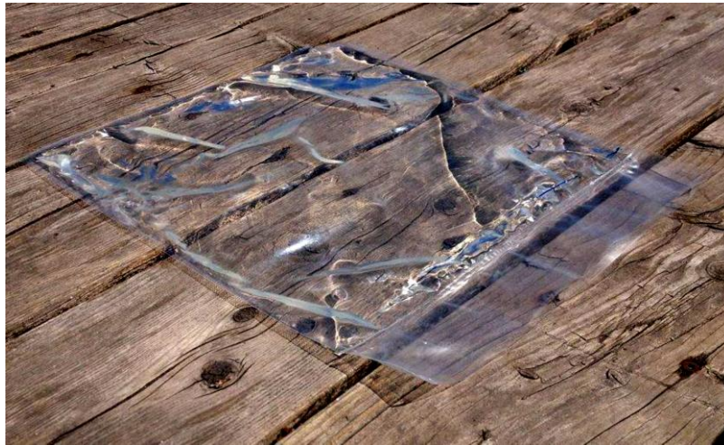
Figure IV.4 : MCP macro encapsulé dans un sachet en Polyéthylène (PE) [19]
