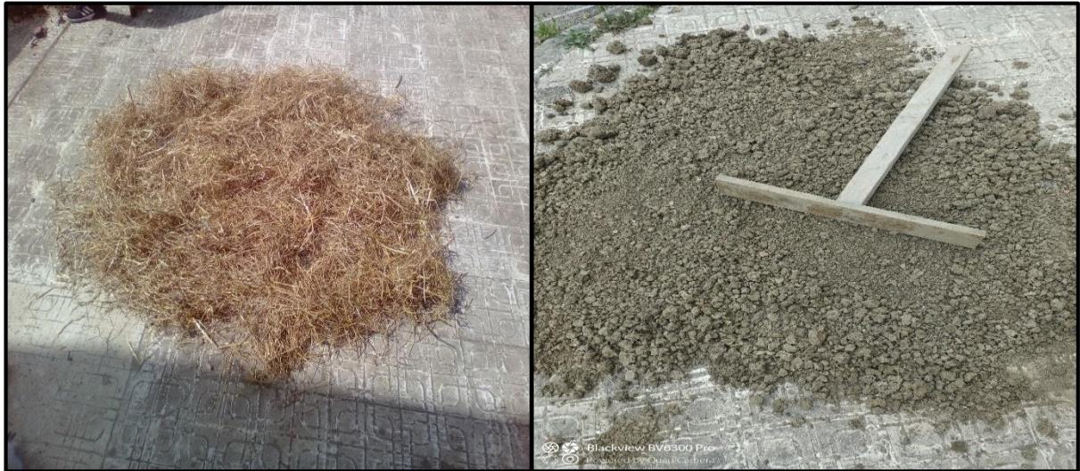
Figure 1.7 : Préparation de la terre et la paille
