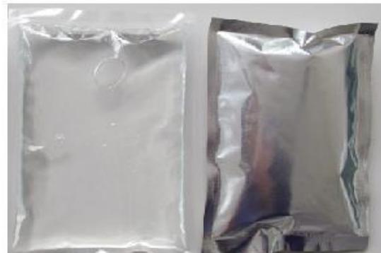
**Sacs en plastique ou aluminium****Figure II.1:** Exemple de MCP macro-encapsulés
