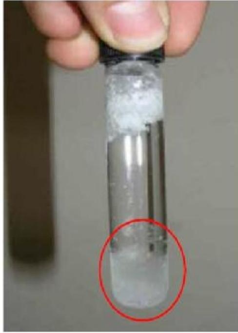
**Figure I.6:** Ségrégation d'un sel hydraté [21].
