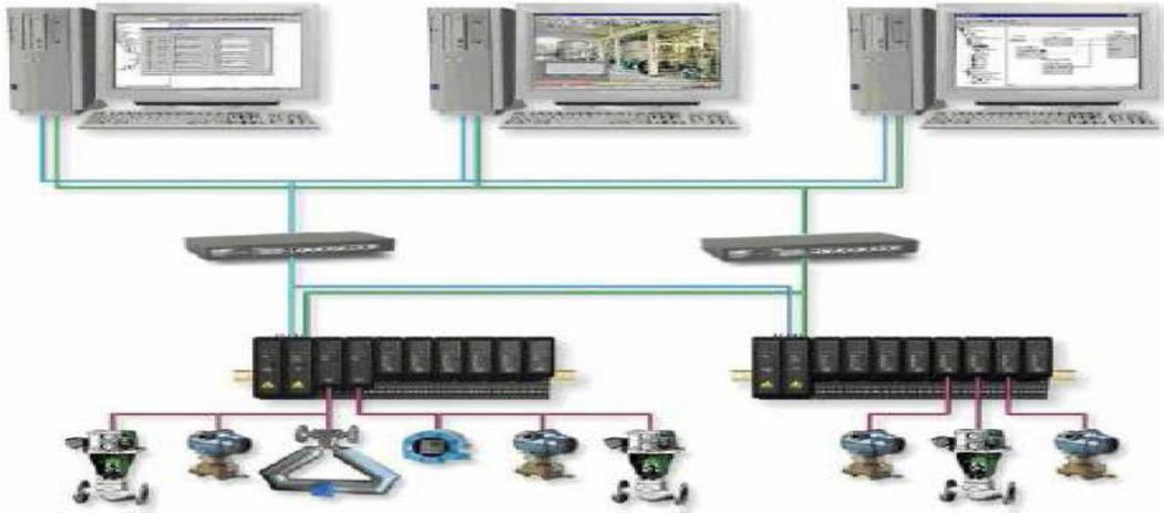
**Figure 4.4:** Structure générale de communication entre le PC de supervision, l'API et le processus.
