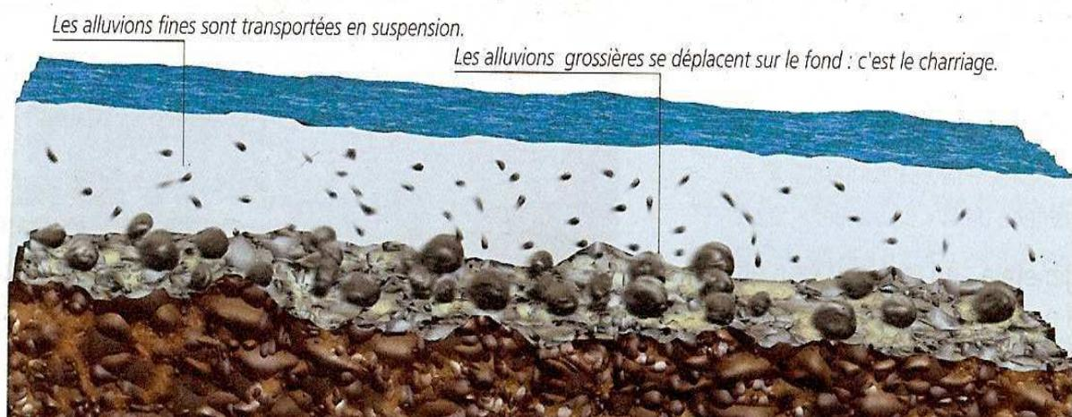
Figure 1.2 : Différents types de transport solide en rivière
