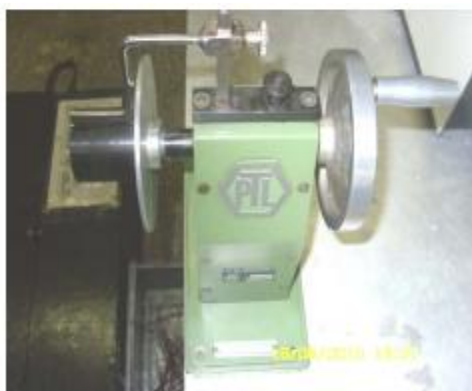
Figure .IV.10 : Appareil pour essai de l'effet ressort
