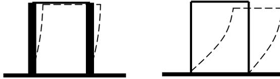
Les deux maquettes sont semblables : même hauteur de poteaux, même matériau des poteaux, même type de liaisons (encastremements), même masse sur le plancher, mais la section des poteaux diffère.
