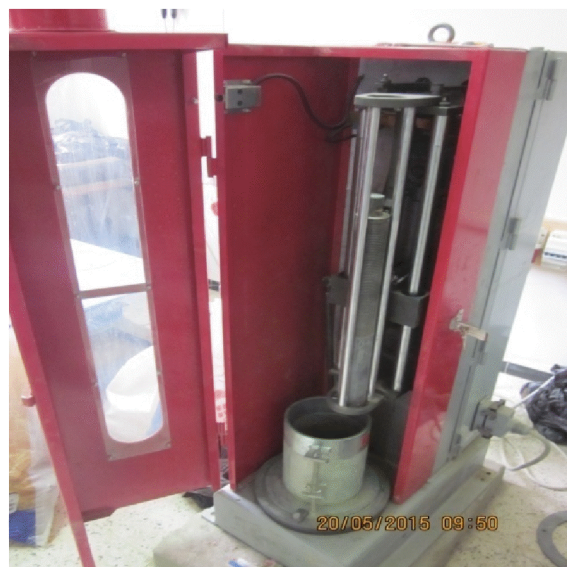
Figure V-27 : La mise en place de l'échantillon
