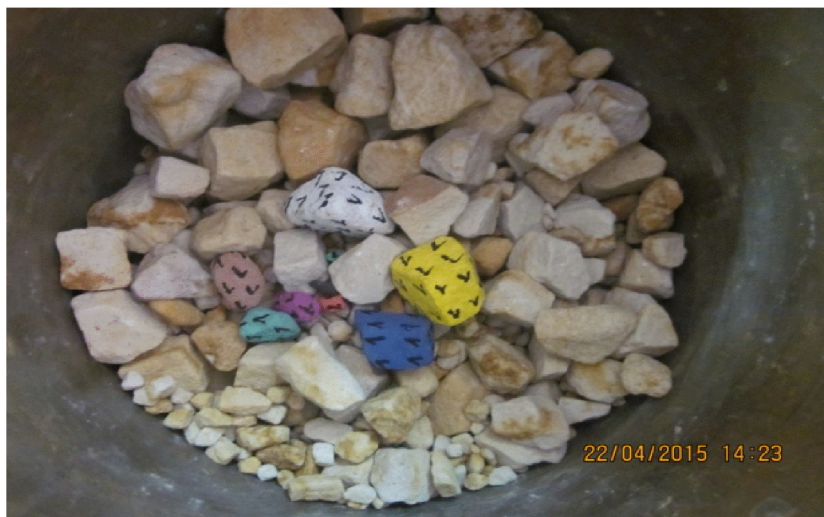
Figure V-28: La position des grains colorés dans le moule
