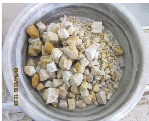
Figure V-14 : La forme sous-arrondie pour le gré
