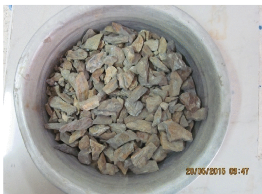
Figure V-13 : La forme allongée pour le schiste
