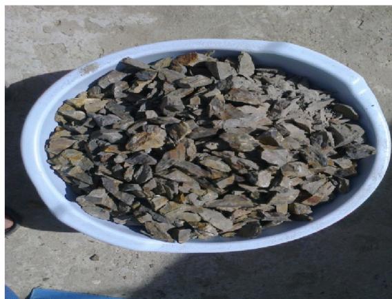
Figure V-10 : Schiste après concassage et tamisage
