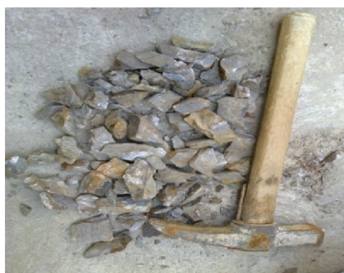
Figure V-8 : Concassage manuel du schiste
