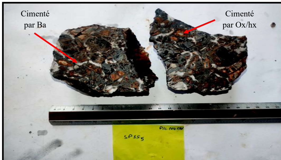
Fig. V. 10 : photo macroscopique d'un échantillon qui montre la cimentation
