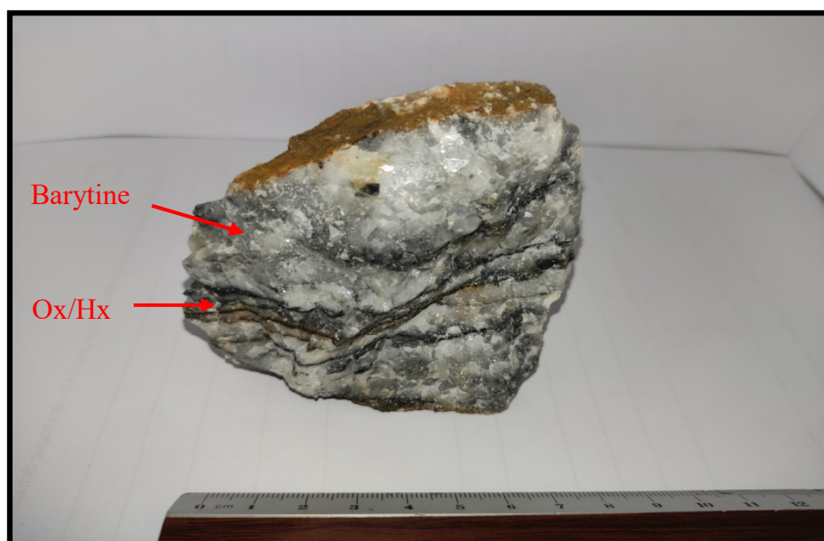
Fig. V. 12: photo macroscopique d'un échantillon de barytine rubanée
