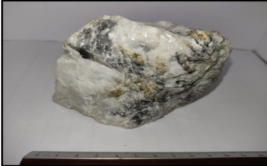
Fig. V. 11: photo macroscopique d'un échantillon de barytine massive associée au cuivre gris.
