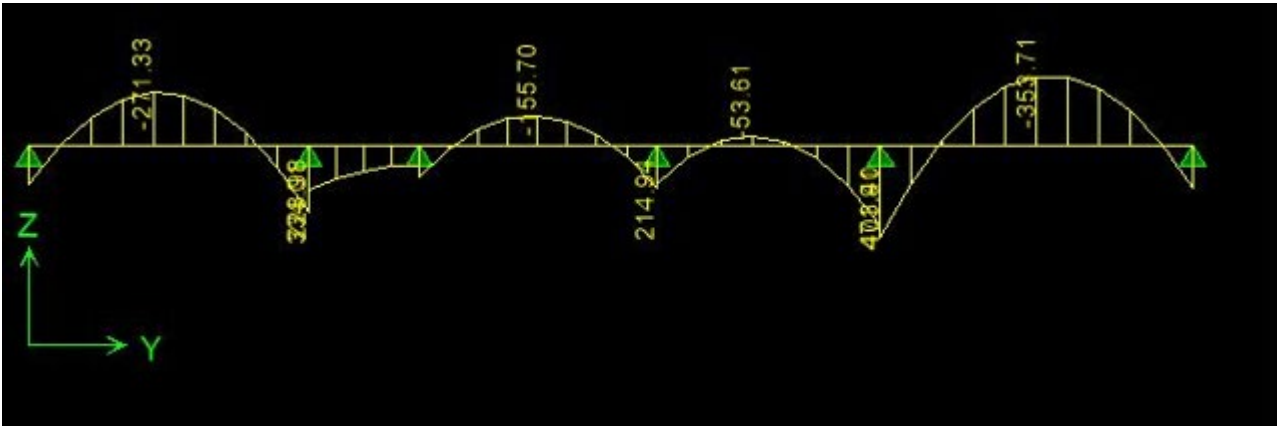
Figure VII.10: Diagramme moments fléchissant à l'ELS.
