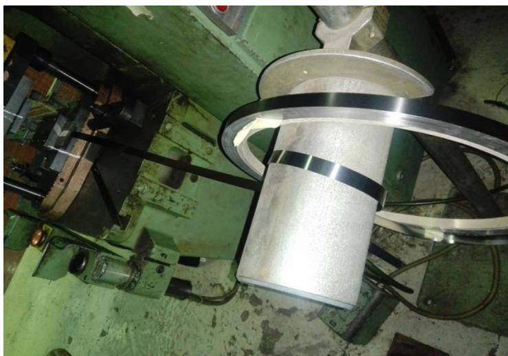
**Figure III-1 :La tôle sous forme de bobine.**
