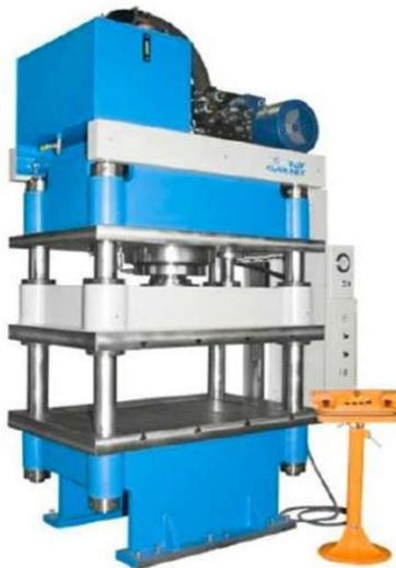
**Figure II- 31 : Presse à colonnes.**
