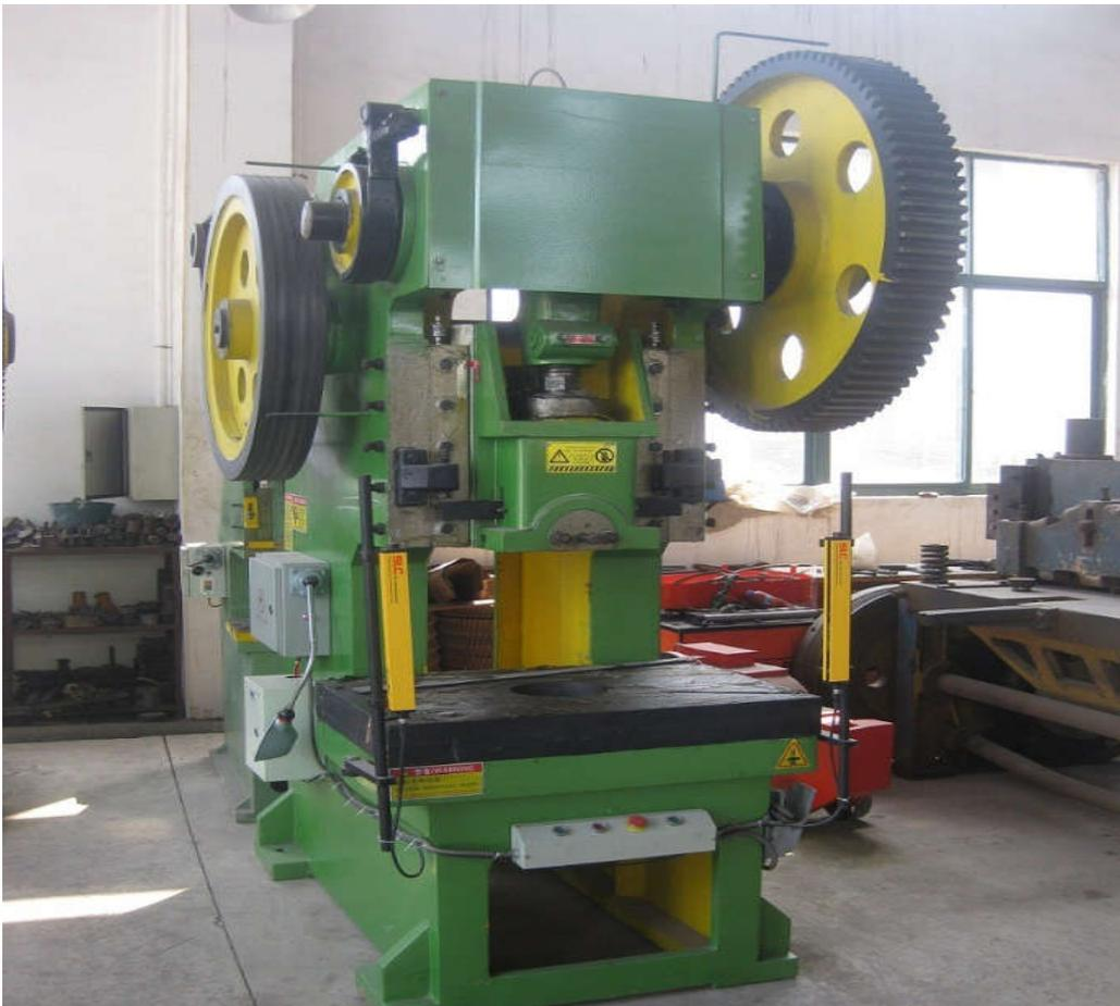
**Figure II- 19 : Presse mécanique.**
