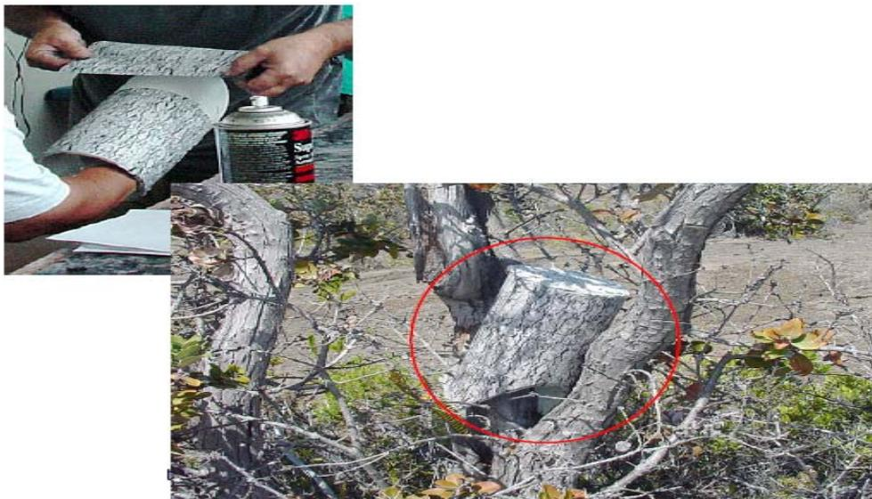
Figure I.10 : Des capteurs dans des fausses branches
