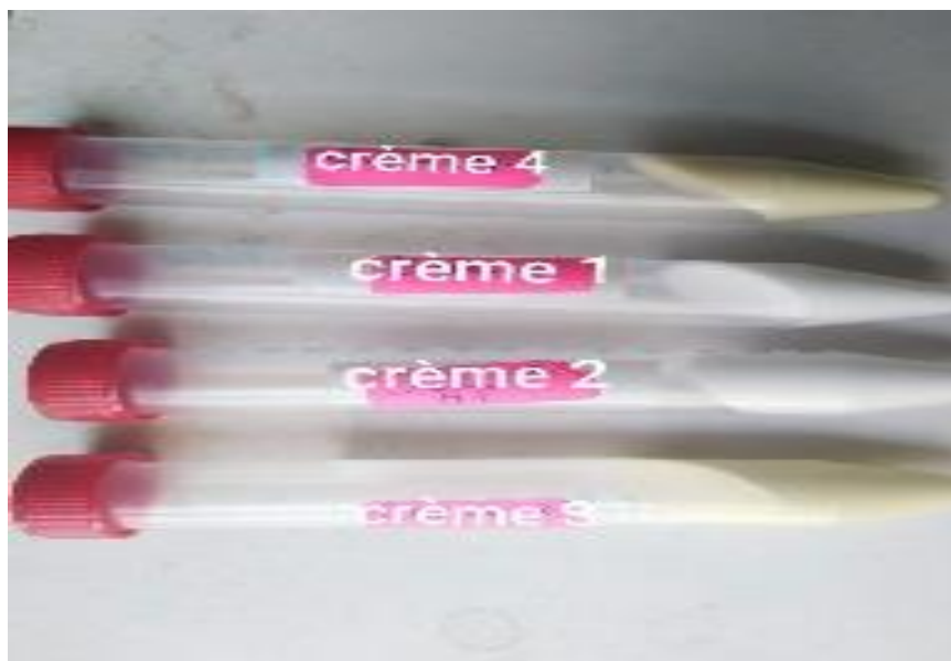
Fig.A.3 : Test de centrifugation pour les crèmes formulées : crème 1 : crème test, crème 2 : à base d'HE, crème 3 : à base d'extrait hydro-méthanoïque, crème 4 : à base d'extrait hydro-éthanolique,
