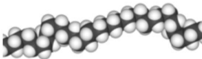
Figure III.2 : Schéma représentatif du polyéthylène
