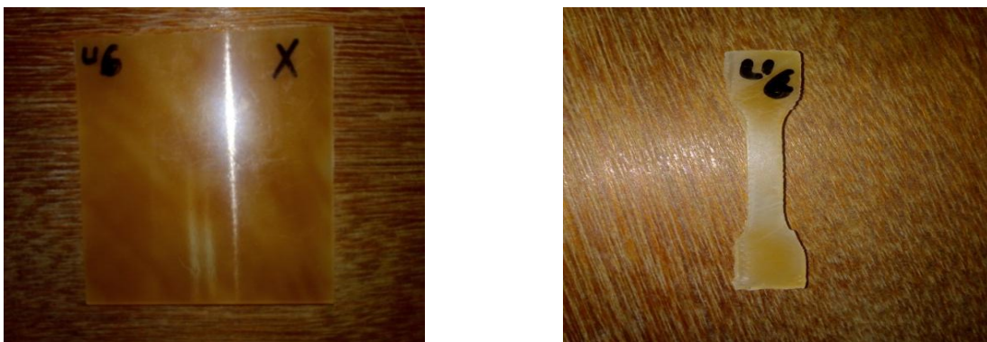
Figure III.5 : Eprouvette pour les essais mécaniques et diélectriques
