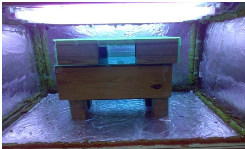
Figure III.7 : Vu d'intérieur de la chambre de vieillissement sous rayonnements ultraviolets
