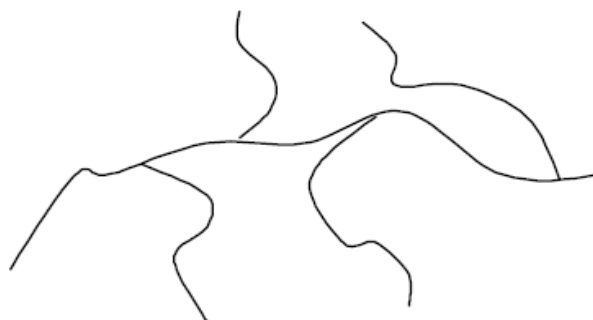
Figure III.3 : Structure de polyéthylène basse densité (LDPE)
