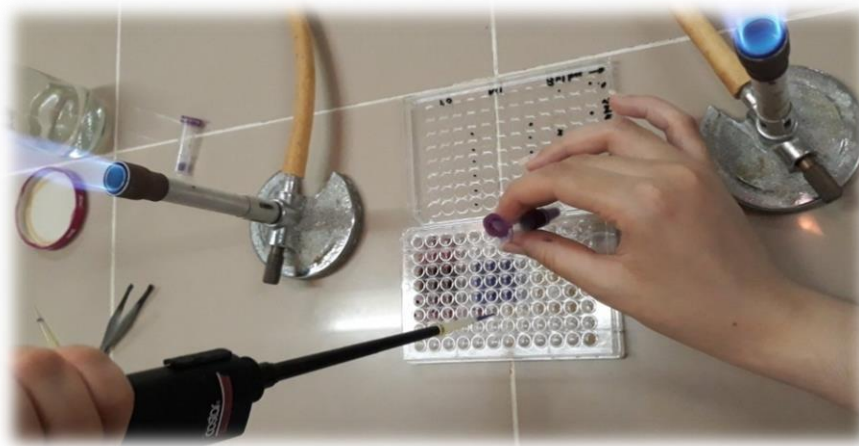
Figure 39: Ajout de l'indicateur coloré pour la lecture (photo prise au labo)
