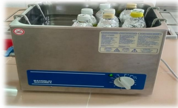
Photo 3: Etape de sonication (photo prise au labo).
