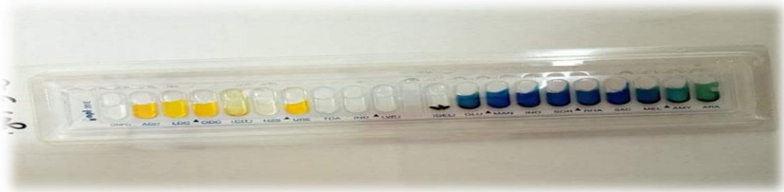
Figure 21: Ensemencement de la galerie biochimique (photo prise au labo)
