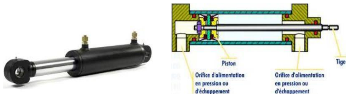
Figure I.17: Vérin pneumatique à double effets
