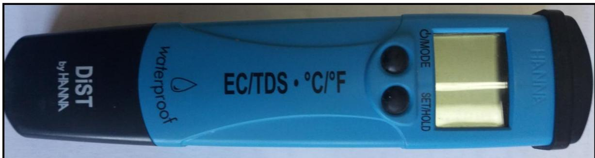
Figure 43 : Photo du conductimètre HANNA HI 98311
