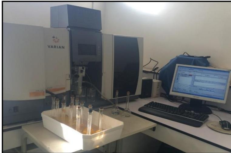
**Figure 40** : Photo du dispositif de spectromètre d'absorption atomique VARIAN AA240.
