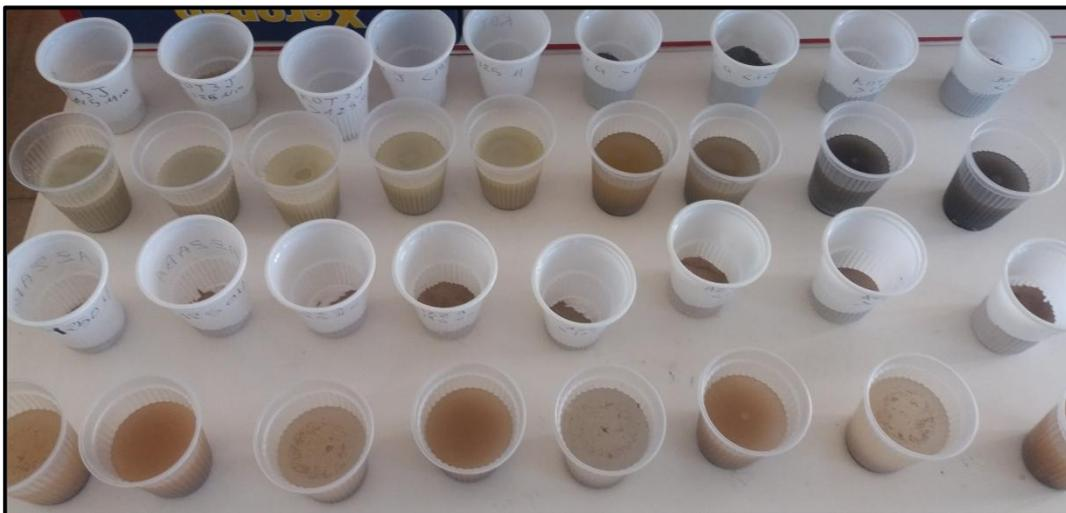
**Figure 41** : une photo des échantillons préparés pour mesurer le ph, redox et conductivité.
