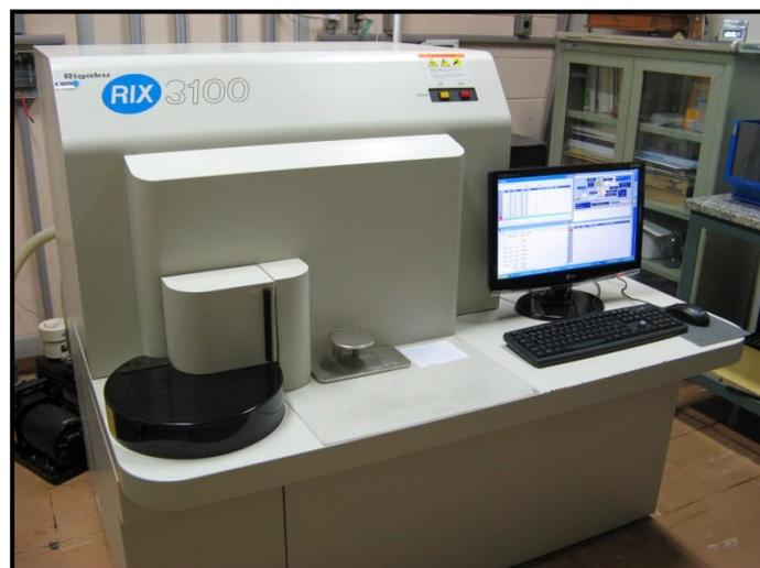
Figure 38 : Image du dispositif RIGAKU RIX 3100.
