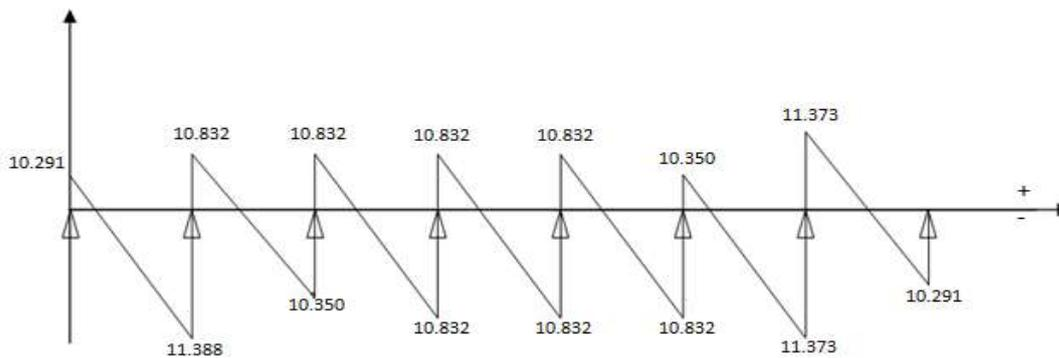
Figure III-2.10 : Diagramme des moments fléchissant à l'ELS
