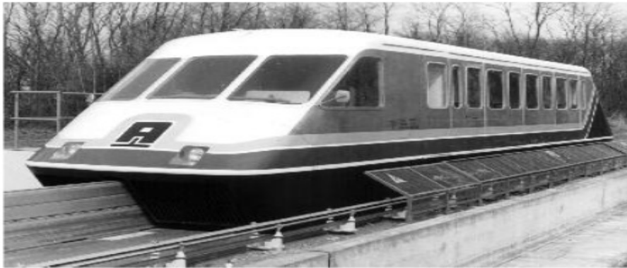
Figure I.3:Image synthétique d'aérotrain suburbain le S44.
