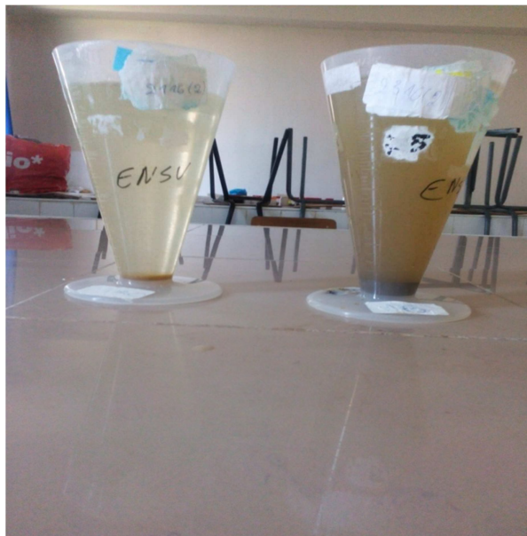
Figure22: Suspension des matières fécales dans des verres à pied (photo HAMEG et LASSAL, 2017)
