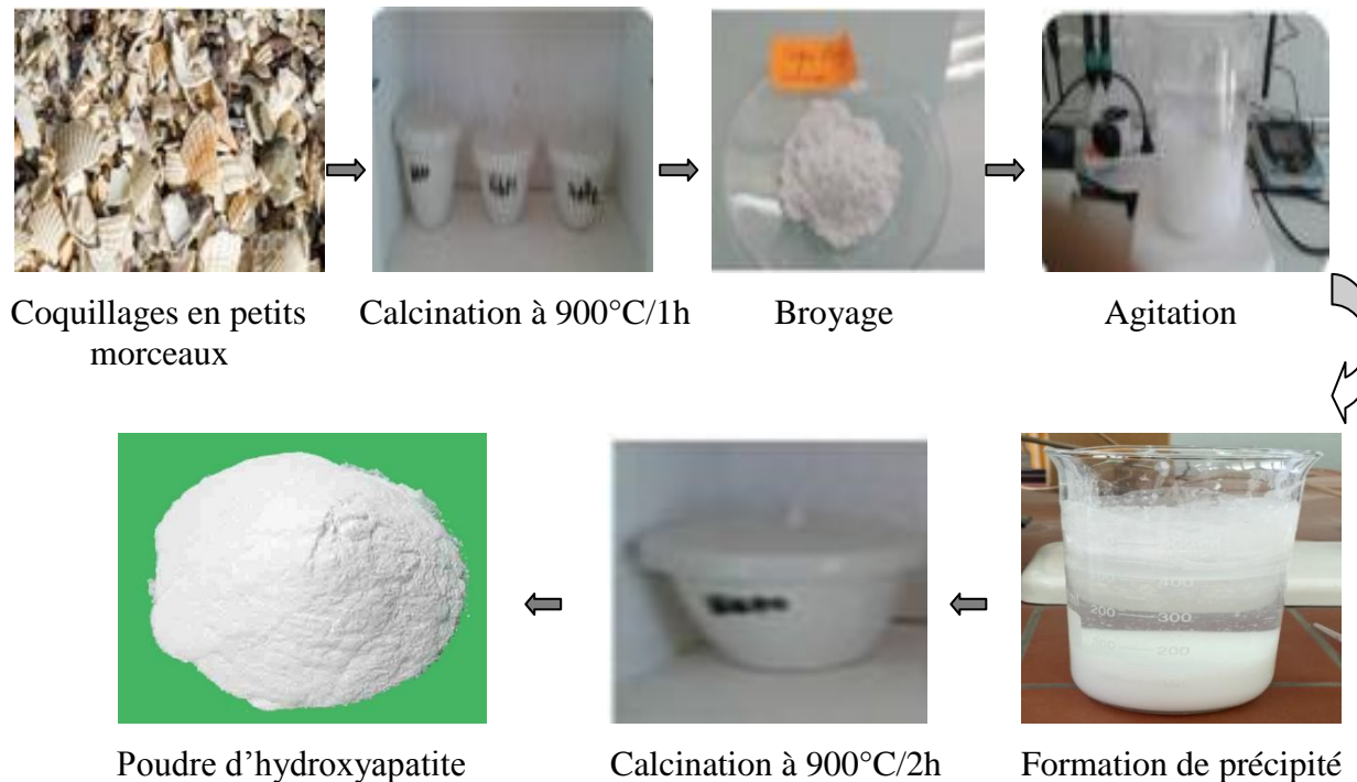
Figure IV.5: Protocole de synthèse de l'hydroxyapatite
