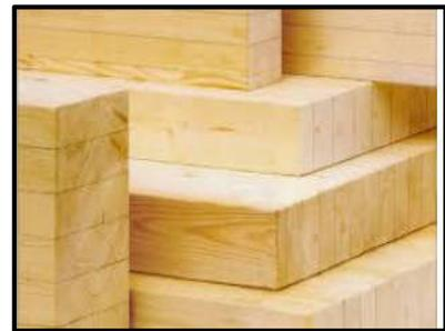
Figure176 : Lamellé collé
