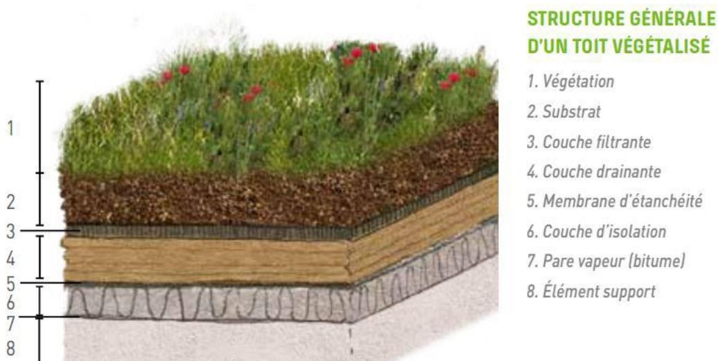
**Fig.66** : Composition de la toiture végétalisée (Guide des plantes de toits végétaux)
