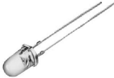
**Figure IV.8 :** source d'infrarouge
