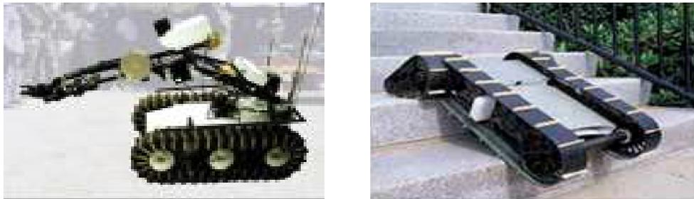
**Figure I. 3 :** robot mobile à chenilles
