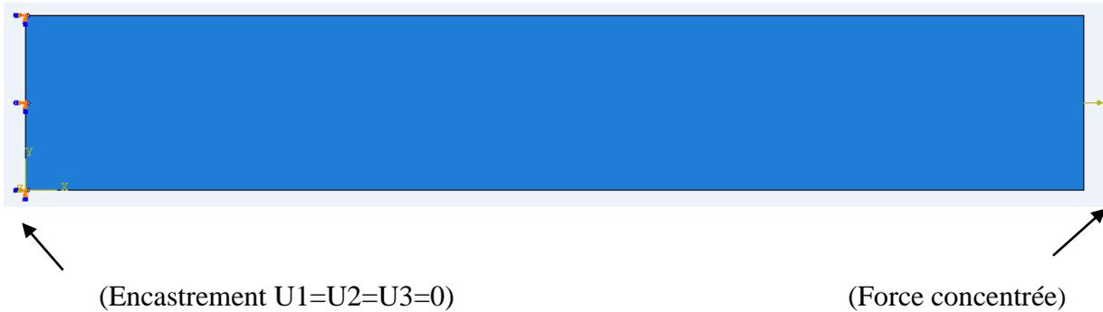
**Figure : IV.4 : l'éprouvette avec les conditions aux limites**
