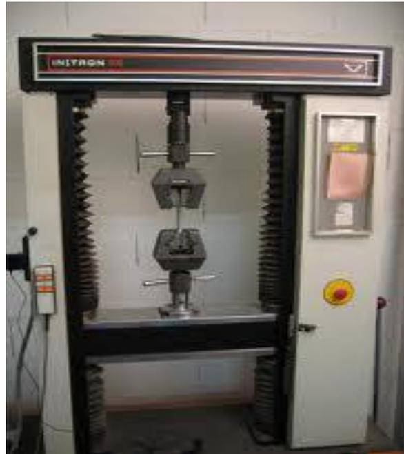
**Figure II.1 : machine de traction**
