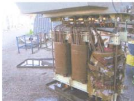
PHOTOS N°3 et N°4 : vue à l'intérieur du transformateur endommagé (Deuxième visite)
