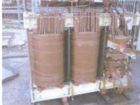
PHOTOS N°3 et N°4 : vue à l'intérieur du transformateur endommagé (Deuxième visite)
