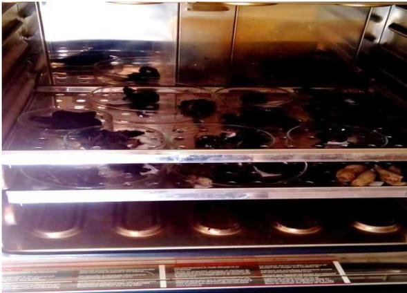
**Figure 11:** Stérilisation des échantillons en étuve (Originale, 2017).
