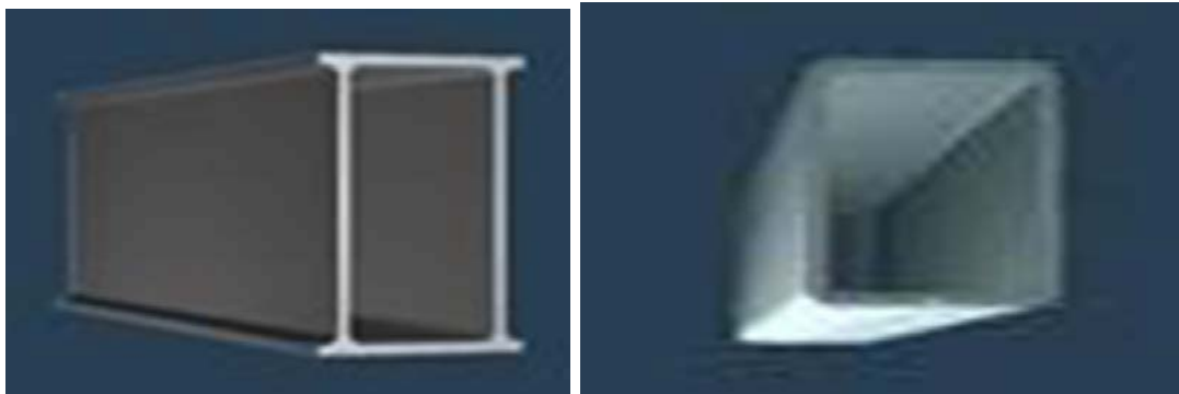
Fig105 Les poutre creuse
