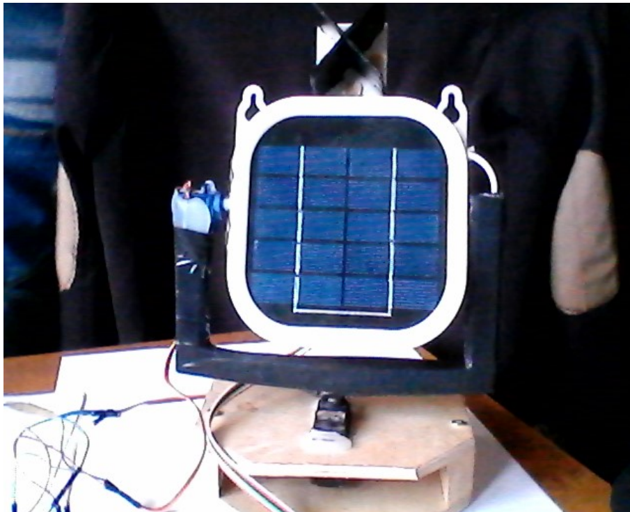
Figure (III.12) : Présentation de notre suiveur finalisée
