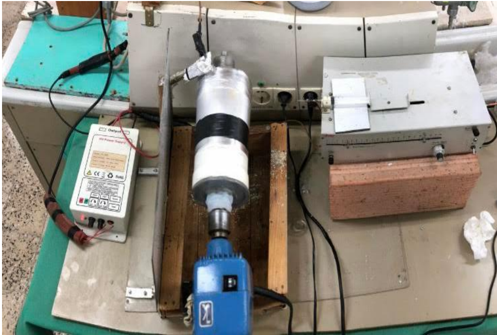
Figure II. 4: Image du dispositif d'électrospinning utilisé
