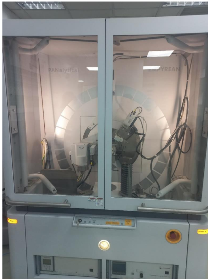
Figure II. 7: Diffractomètre des rayons-X (DRX)
