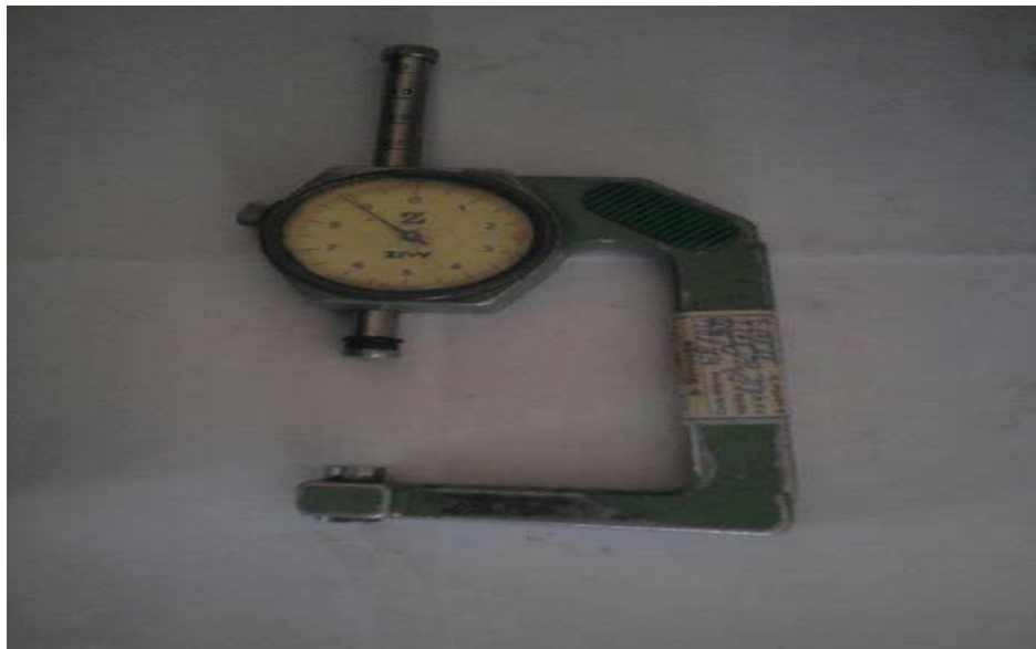
Figure IV.7 : Palmer utiliser pour la mesure des épaisseurs.
