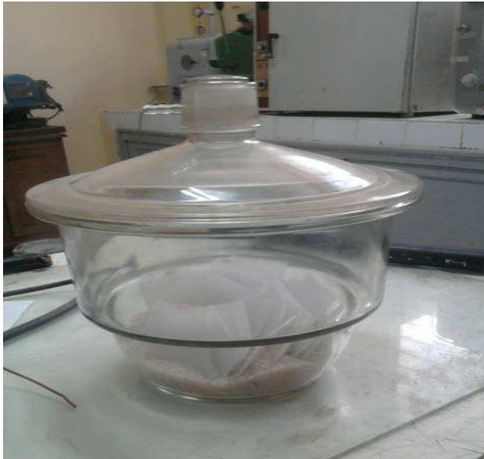
Figure VI.8 : Dessiccateur avec échantillons au cours de conditionnement.
