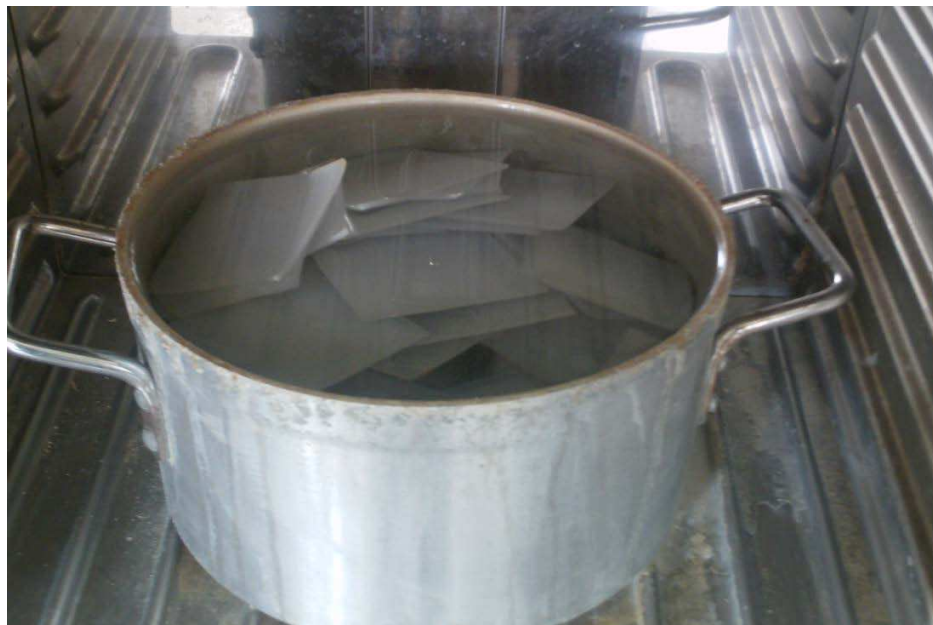
Figure IV.3 : Échantillons durant le vieillissement hydrothermique.
