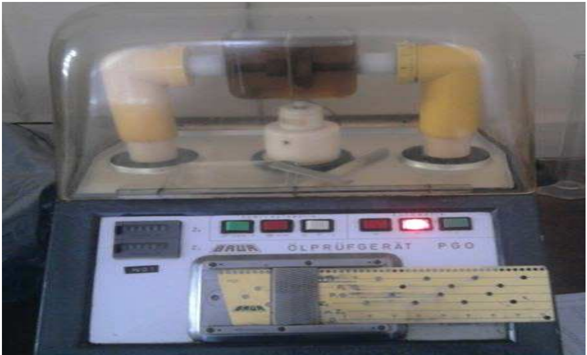
Figure IV.5 : Spintermètre automatique utilisé pour les essais de claquage.
