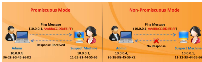
Figure IV.1 : Détection d'un Sniffer en utilisant la méthode ping
