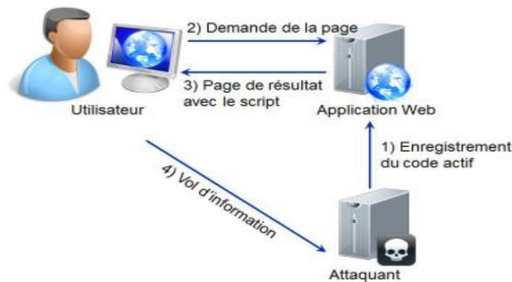
Figure II.23: Principe d'une attaque XSS stockée
