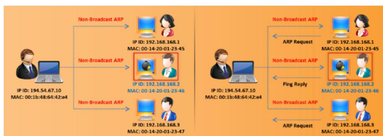
Figure IV.2 : Détection d'un Sniffer en utilisant la méthode ARP
