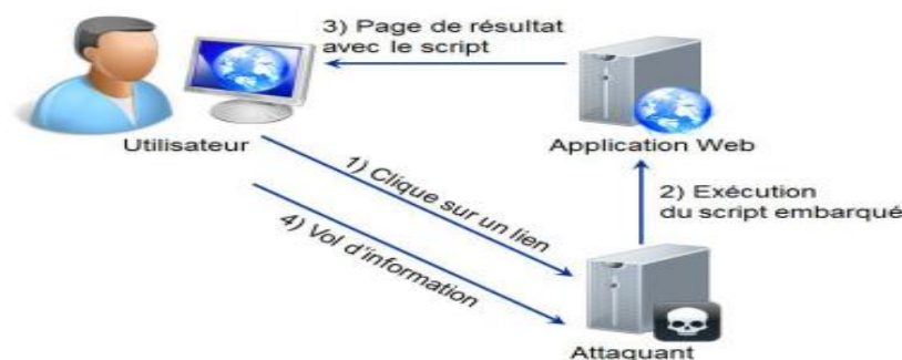
Figure II.22: Principe d'une attaque XSS par réflexion
