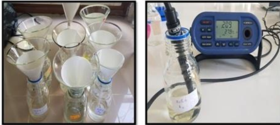
Figure 9 : Etapes suivies pour la détermination de la conductivité électrique.
