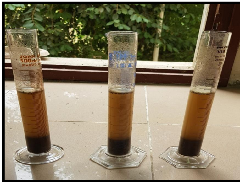
Figure 6 : Etapes suivies pour la détermination de la granulométrie des trois sols de Bouzeguène.
