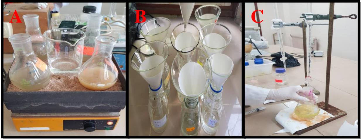
Figure 10 : Etapes suivies pour la détermination du calcaire total.
