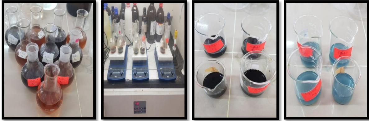
Figure 11 : Etapes suivies pour la détermination du carbone organique.
