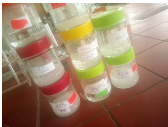
Figure II-8 : Solutions salines utilisées pour le capteur d'humidité
