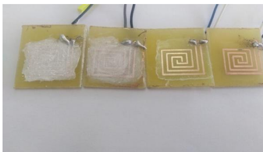
Figure II-9 : (a) capteur à blanc. (b) capteur recouvert de film de chitosane, (c) Chitosane-1% ZnO et (d) chitosane 3% ZnO
