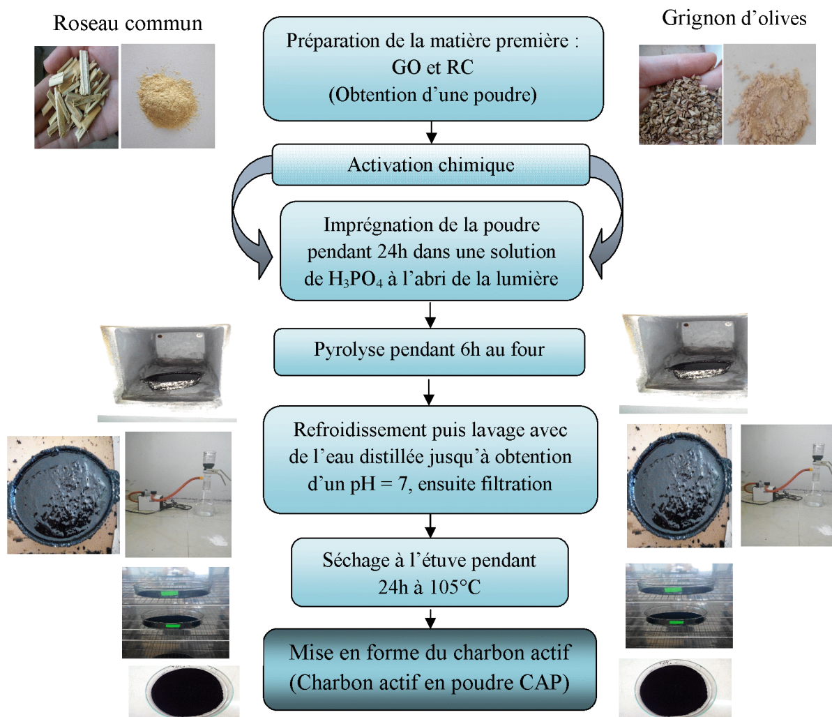
Figure N°20: Schéma général de la fabrication du charbon actif à base du GO et du RC
